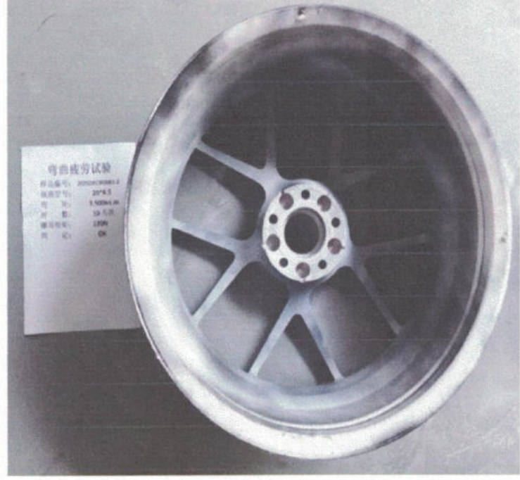
弯曲试验后: 反面照片 评价: 符合
