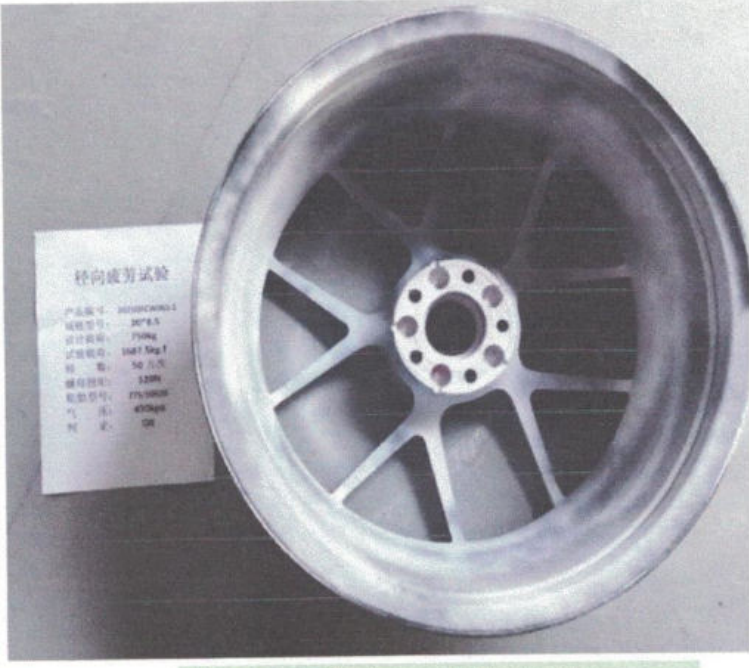
径向试验后: 反面照片 评价: 符合
